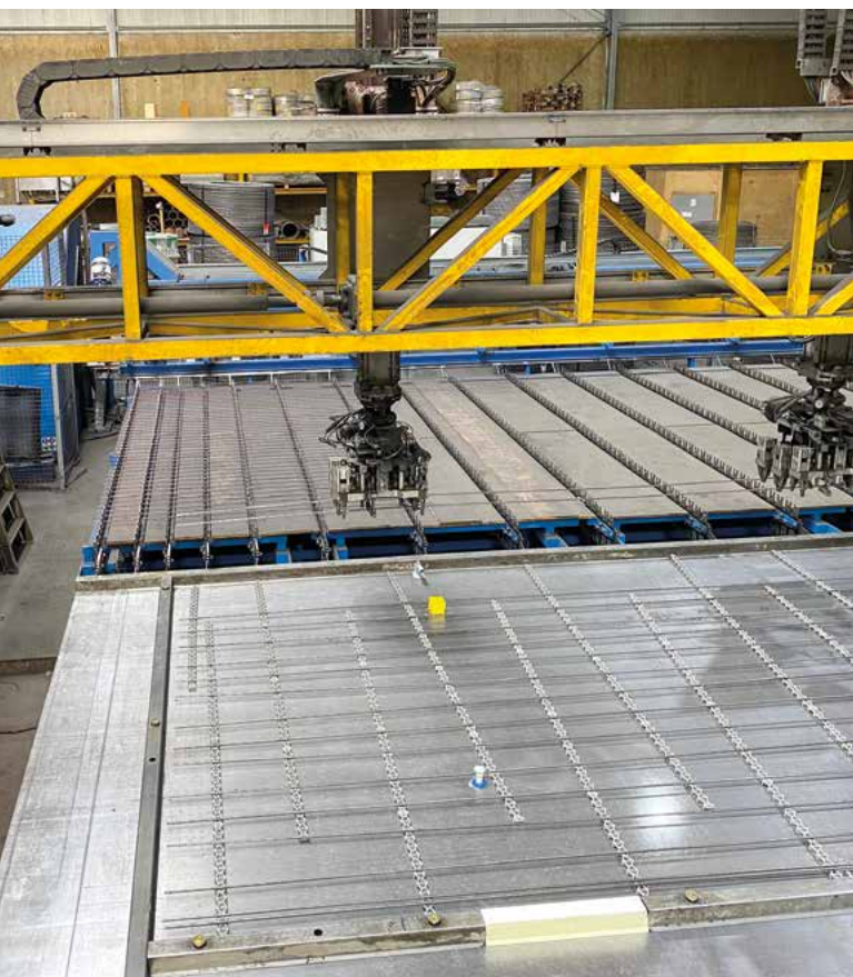
La pince de pose EPT sextuple fonctionne de manière entièrement automatique selon les spécifications CAO-FAO.
