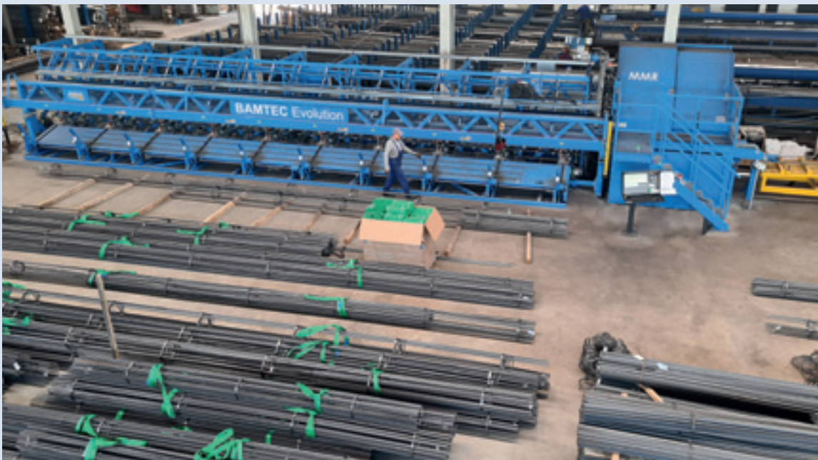
Betonstahl wird bei Katmet in Zukunft gerollt und nicht geflochten.
