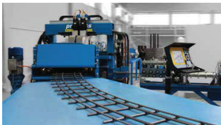
The Tunnel Master welds straight and bent ladders off coil Der Tunnel Master schweißt gerade und gebogene Leitern vom Coil
