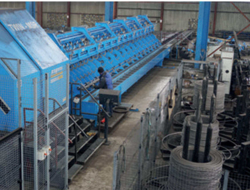
Richtschneide-Biegemaschinen des Typs MSR und Twin MSR der progress Maschinen + Automation tragen zu einer kosteneffizienten Produktion bei. Die Maschinen arbeiten vom Coil und optimieren so den Produktionsfluss.
